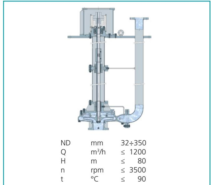
Le pompe serie VS sono pompe monostadio verticali sospese con linea d'asse e piastra di base. I componenti principali derivano dalle pompe serie MU o serie MCA. Vengono impiegate per il pompaggio di acque di drenaggio da vasche di raccolta, recupero condensa, trasferimenti emulsioni e liquidi chimicamente aggressivi, trattamento acque o fanghi, ecc.. Sono impiegate in tutte quelle applicazioni dove è necessario installare le pompe direttamente sulle vasche o sui serbatoi metallici.
