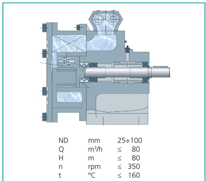
*La particolare realizzazione delle pompe P permette di impiegarle in vari settori come quello navale, chimico e petrolchimico, cartario, alimentare, vernici ecc.. Possono pompare i liquidi più diversi, da quelli viscosi a quelli più volatili, da quelli lubrificanti a quelli secchi e quindi grippanti, fluidi parzialmente abrasivi, fluidi aggressivi, ecc..*
